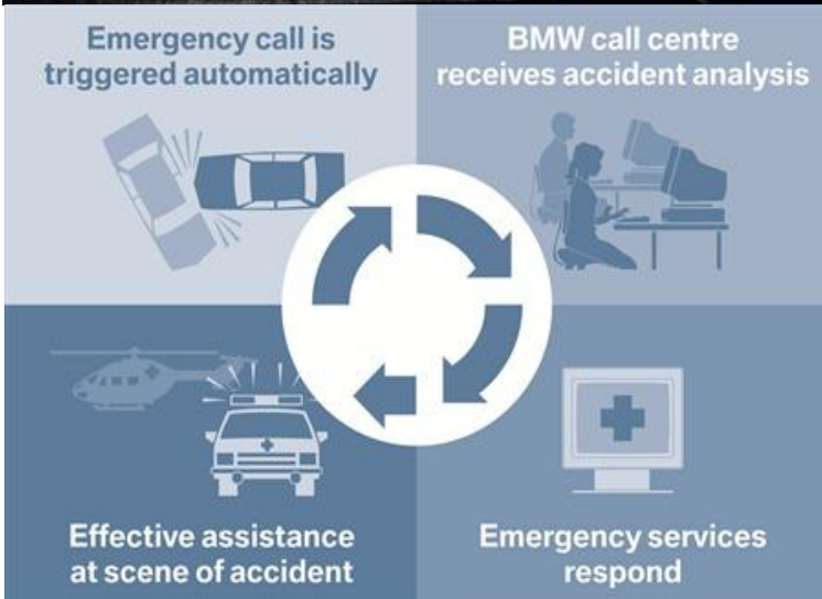
شکل ۹ مراحل عملکرد eCall پس از حادثه و فعال شدن سیستم هنگام تصادف
