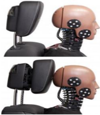
شکل ۲ - انواع مختلف محافظ سر واکنش پذیر هنگام تصادف و عملکرد آنها
