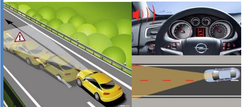
شکل ۶- نحوه عملکرد شماتیک خودرو هنگام استفاده از سیستم نگهدارنده
