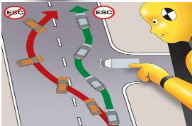
شکل ۳ - تفاوت در عملکرد خودرو مجهز به ESC با خودرو فاقد آن
